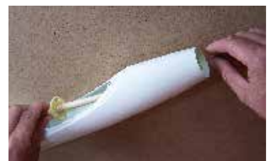
106. Motorovou přepážku #1-1 navlékneme na vhodnou kulatinu a vsuneme ji do trupu... Insert motor wicket #1-1 to the fuselage, use appropriate round pole ...
