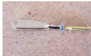
153. Sestavíme koncovku táhla #4-6 Assembly clevis set #4-6 of the pushrod.
