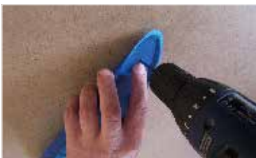
79. ...vyvrtáme otvor Ø3mm ... ... drill hole ø 3 mm ...
