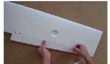
16. Pomocí kvalitní pásky přilepíme klapku #2-11 ke střední části křídla #2... Glue flap #2-11 on central part of the wing #2, use quality adhesive tape ...
