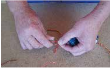
28. ...všechny konce kabelů odizolujeme a pocínujeme ... cut insulate and solder all end of the cables.
