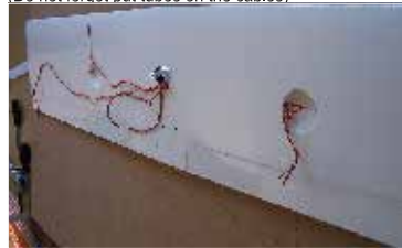
34. ...protáhneme kabel křídélkem... ... pass aileron cables through wing ...
