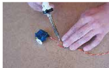
41. ...připájíme prodlužovací kabel (nezapomeneme na bužírku)... ... solder extension cable (do not forget put tubes) ...
