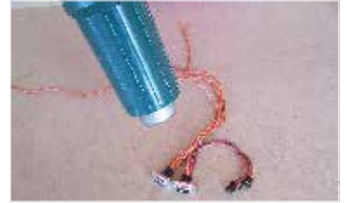
31. Bužírku "smrštíme" pomocí vhodného zdroje tepla Shring tubes, use appropriate heat source.
