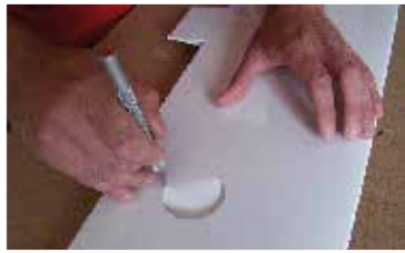
2. Na křídle #2 odstraníme potahovou folii z otvorů pro serva Remove facing foil from holes for servos on the wing #2. ...
