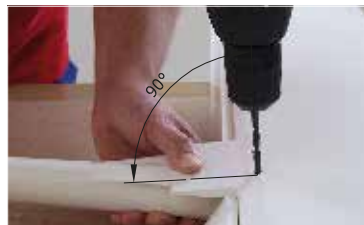
101. Vyvrtáme otvory Ø4,9mm... Drill holes \varnothing 4.9 mm ...
