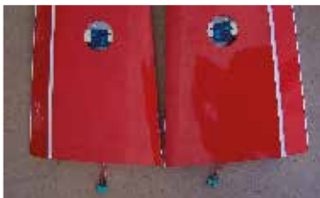
61. Obě serva křídledek vlepěná do křídla Both aileron servos assembled in the wing.
