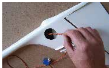
129. Kabel serva výškovky vsuneme do trupu... Insert elevator servo cable to the fuselage ...
