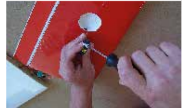
56. Nasadíme páku a přišroubujeme ji Fit and screw servo arm on the servo.
