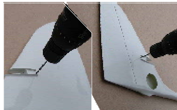
89. Vrtákem Ø3,1mm převrtáme otvor pro pro čep páky #3-81 Drill hole \varnothing 3.1 mm for arm pin #3-81.
