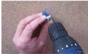
120. Otvor v páce serva převrtáme na Ø2mm... Drill servo arm hole Ø 2 mm ...
