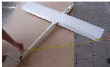
100. ...vzdálenosti musí být stejné! ... distances must be same!
