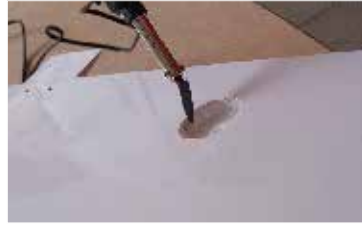
7. Okraje otvorů zažehlíme... Iron borders of the holes ...
