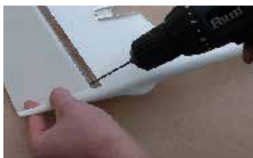
155. V klapce směrovky vyvrtáme otvor Ø3,2, pro páku #4-8... V klapce směrovky vyvrtáme otvor Ø 3.2 mm, pro páku #4-8 ...
