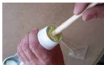
109. ...přepážku vlepíme do trupu... ... glue wicket to the fuselage ...
