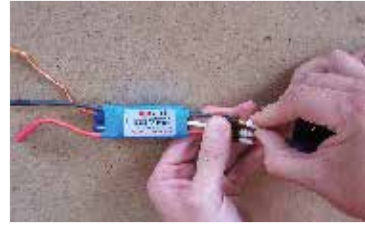
137. ...regulátor připojíme k motoru... ... connect controller with motor ...
