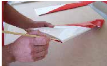
14. Do otvoru pro aretační kolík #2-21, ve vnější části křídla nanese se lepidlo Put glue to hole for fixing pin #2-21 on outer part of the wing.
