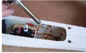
180. ...k páce serva připojíme koncovku #4-6, navlékneme táhlo (popř. upravíme jeho délku) a celek zapájíme... ... mount clevis set #4-6 to the servo arm, insert pushrod (reduce length when required) and solder pushrod unit ...
