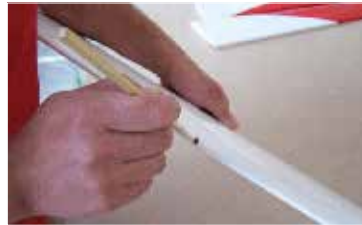
11. Potřebné množství lepidla nanese do otvoru pro upevňovací kolík #2-25, ve střední části křídla Put required amount of the glue to hole for fixing pin #2-25 on central part of the wing.
