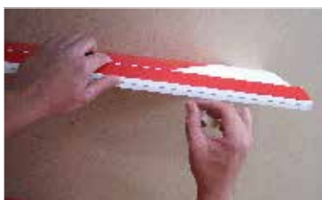
21. Křídélko "přehneme" a páskou přelepíme také druhou stranu... Turn aileron and glue other side, use adhesive tape ...
