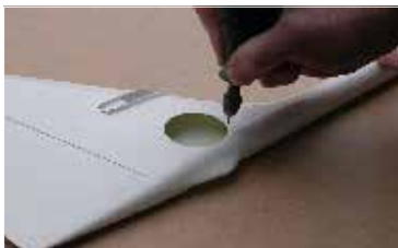
87. V kýllovce vyfrézujeme otvor pro servo výškovky... Shape hole for elevator servo in the fin ...
