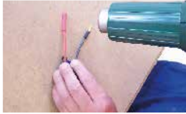
136. ...opatříme je izolací... ... insert insulation tubes ...
