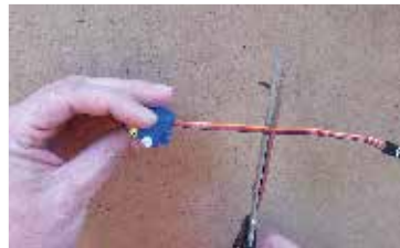
113. ...rozpůlíme kabel serva... ... halve servo cable ...
