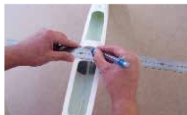
84. Na trupu si naznačíme osu otvoru pro kolík křídla #2-25... Mark hole axe for wing pin #2-25 on the fuselage ...
