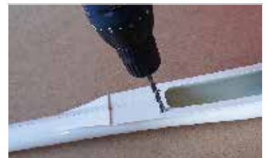
102. ...otvory převrtáme na Ø6,2mm, dbáme na dodržení směru vrtání a souososti obou otvorů... ... redrill holes \varnothing 6.2 mm, be sure correct orientation and collinearity for both holes ...
