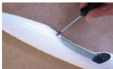
83. ...zašroubování / vyšroubováním vrtu #6-1 ... doladíme zajištění kabiny na trupu ... adjust lock of the cockpit by screw on/screw off wood screw #6-1.
