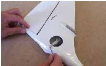
123. Páku #3-8 vsuneme otvorem pro servo do kýlovky, vystředíme s otvorem Ø3,1mm... Insert arm #3-8 through servo hole to the fin, adjust arm axle to centre of hole Ø 3.1 mm ...
