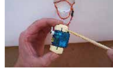
51. ...na styčné plochy držáků nanese 5 min. epoxi... ... put glue (5-min EPOXI) to montage surface of the holders ...
