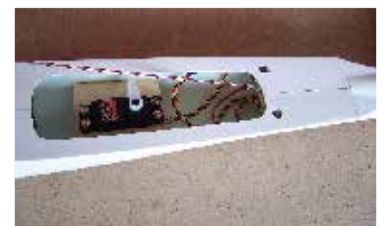
158. Do "vedení" táhla vsuneme táhlo #4-5... Insert pushrod #4-5 to the linkage ...
