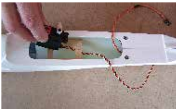
151. Servo vložíme do trupu... Insert servo to the fuselage ...
