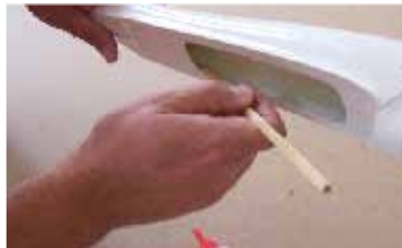
96. Do trupu, v místě, kde budou matice křídla #2-3, nanese me zahuštěný 30 min. epoxi... Put thicken 30-min EPOXI to place for wing nut #2-3.
