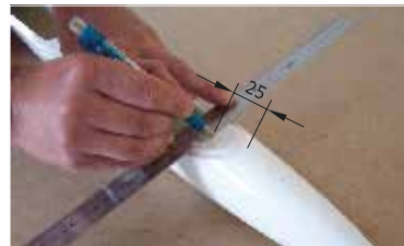
74. Na trupu si naměříme polohu šroubu #6-1 (v ose trupu) Measure position of the screw #6-1 (in fuselage axe) ...
