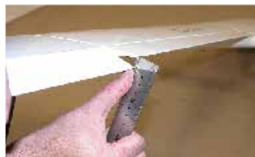
190. Křídélka dolů = 10 - 15mm... Ailerons down = 10 - 15 mm ...
