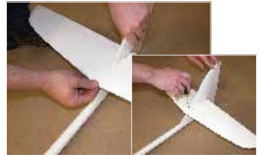
186. Model sestavíme a vyvážíme Assembly airplane and balanced it.
