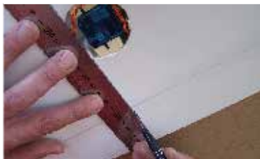
69. Na klapce #2-11 si označíma polohu páky #2-8... Mark arm #2-8 position on the flap #2-11 ...
