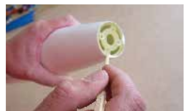
110. ...pojistíme lepidlem i z vnější strany ... fix it by glue from outside.
