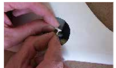
130. ...do otvoru vsuneme srva a připojíme páku výškovky (popř. šroubováním upravíme délku)... ... insert servos to the hole and connect elevator arm (adjust length by screw when required) ...
