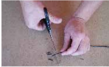
29. Připravíme si kousky bužírky dlouhé cca 12mm Prepare piece of the insulating tubes about 12mm length.
