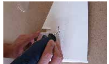
90. Zhotovíme drážku pro ovládání výškovky Shape slot for elevator controller.
