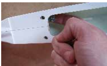
103. ...vtlačíme matice #2-3... ... stuff nuts #2-3 ...
