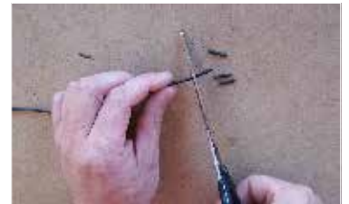
114. ...připravíme si bužírku... ... prepare insulate tubes ...
