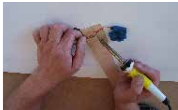
37. Ke kabelu připájíme kabel serva klapkek (nezapomeneme na bužírku), povrch folie chráníme proti propálení Solder flap servo cable (do not forget put tubes on the cables), you must protect surface of the foil before burn-out.
