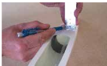
85. ...výšku otvoru si odměříme na křídle... ... hole distance you can measured on wing ...
