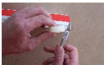
22. ...odřízeme okraje ... cut exceed parts of the adhesive tape.
