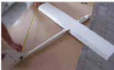
99. Na trup nasadíme křídlo a ustavíme je do správné polohy... Insert wing onto fuselage and adjust to the correct position ...
