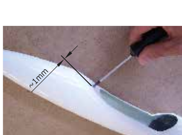
76. ... zašroubojeme vrut #6-1 ... screw on wood screw #6-1.
