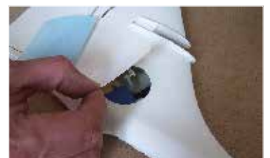
134. Po odzkoušení funkce a seřízení otvor přelepíme samolepkou Cover hole with adhesive tape after functional testing and adjusting.
