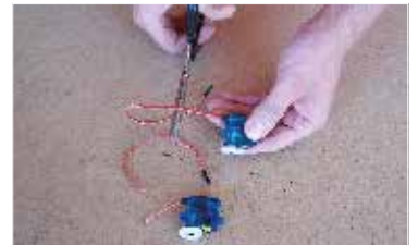
27. Rozpůlíme servokabely... Halve servo cables ...
