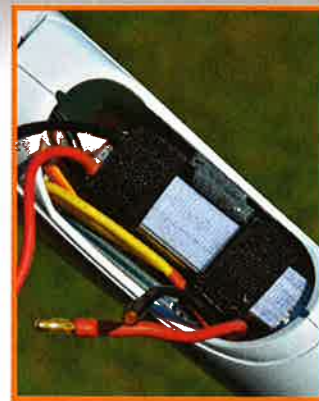
L'accu 3S 2200 mAh employé par l'auteur n'est pas assez lourd pour centrer le modèle avec le moteur utilisé, plus léger que celui préconisé par le constructeur. Il a fallu ajouter un peu de plomb, la honte ! ;o)
