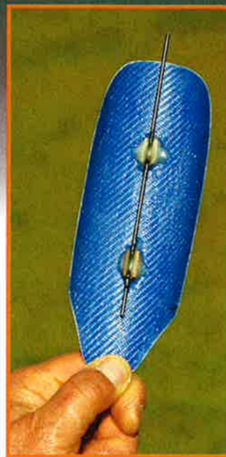
Verrouillage classique de verrière par jonc carbone faisant ressort.
