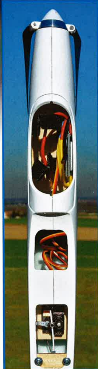
Du fait de la légèreté de sa motorisation, Thierry a choisi de placer le servo de profondeur à côté de celui de la direction.
