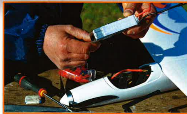
L'accu 3S 2200 mAh employé par l'auteur n'est pas assez lourd pour centrer le modèle avec le moteur utilisé, plus léger que celui préconisé par le constructeur. Il a fallu ajouter un peu de plomb, la honte ! ;o)
