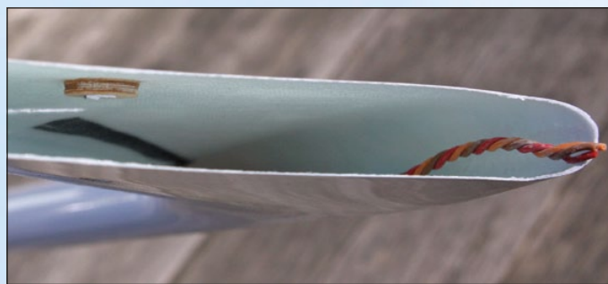
Laminátová kýlovka s připravenými překližkovými ložisky páky plouvající výškovky
